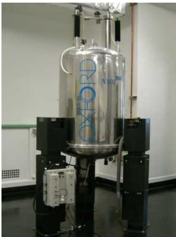
სურ. 22 Varian 400 MHz NMR ბირთვულ-მაგნიტური რეზონანსის სპექტრომეტრი
