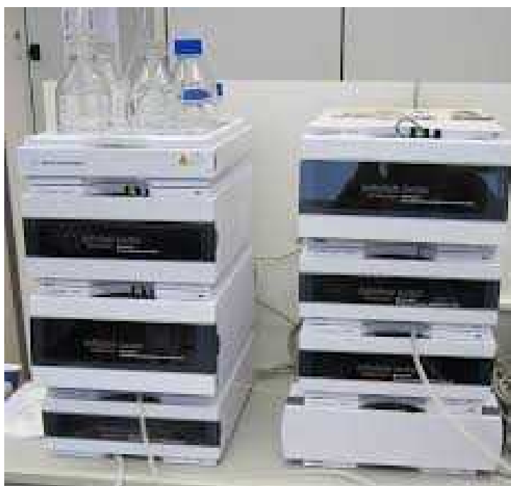
სურ. 21 Agilent 1200 სერიის მაღალეფექტური სითხური ქრომატოგრაფი
